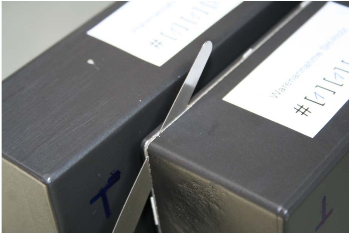
Abbildung 9: Ablösungsschaden Aluminiumfolie zu Rahmenholz nach Klima e (Prüfkörper #1185-01)
